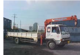
รถปั้นจั่น UNIC CRANE
