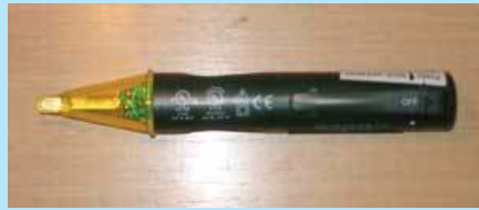
เครื่องตรวจจับกำลังไฟฟ้า (Noncontact voltage detector) ใช้เพื่อตรวจสอบว่าอุปกรณ์ควบคุมไฟฟ้าชนิดต่าง ๆ ยังมีไฟเดินอยู่หรือไม่
